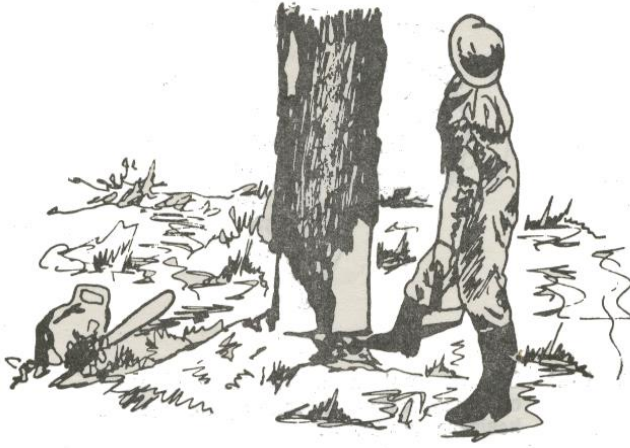
ŞEKİL-24 Motorlu testereyle yapılan kesimde kamaların çakılması.
