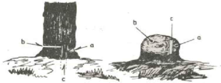
ŞEKİL - 2 a = Devirme kertiği b = Devirme kesisi c = Kopma seridi
